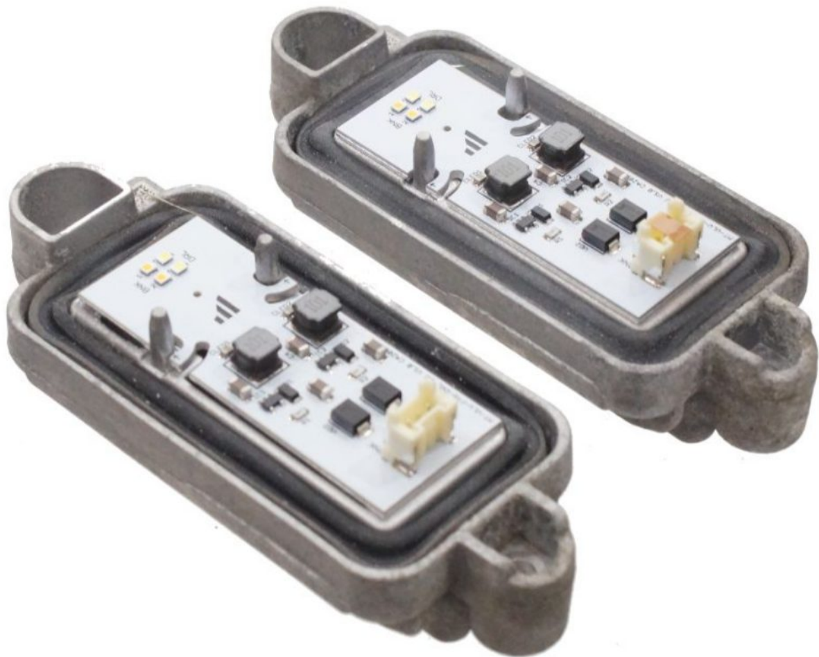
Emitter på kylflänsen – böj vingarna vid pilarna
