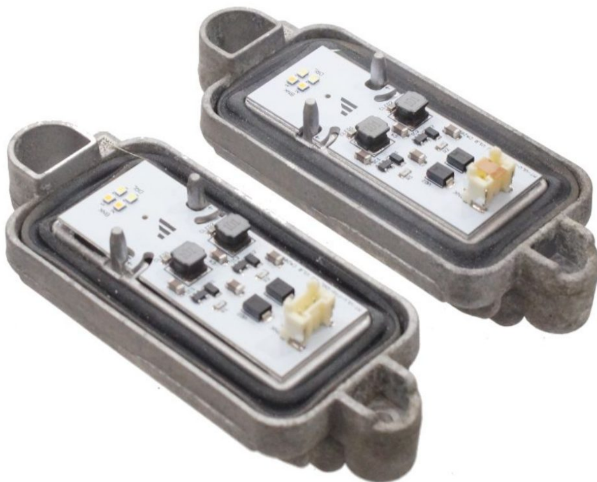
Emitter på køleprofilen – bøj vingerne ved pilene
