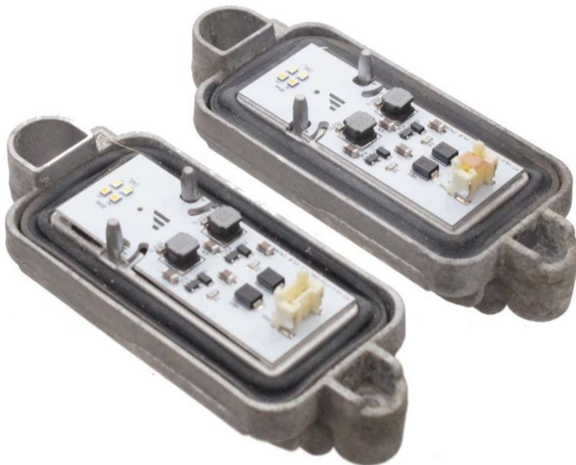
Emettitore sul dissipatore – piegare le alette in corrispondenza delle frecce
