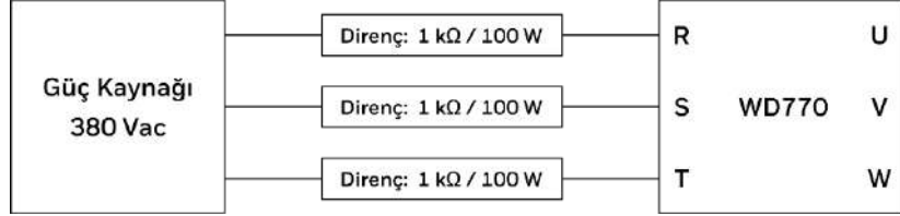
Şekil 8-4: 380 Volt için Pre-şarj devresi örneği.
