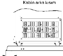
Şekil C-15: 220 – 500 kW arası WD770 için temel montaj aparatı
